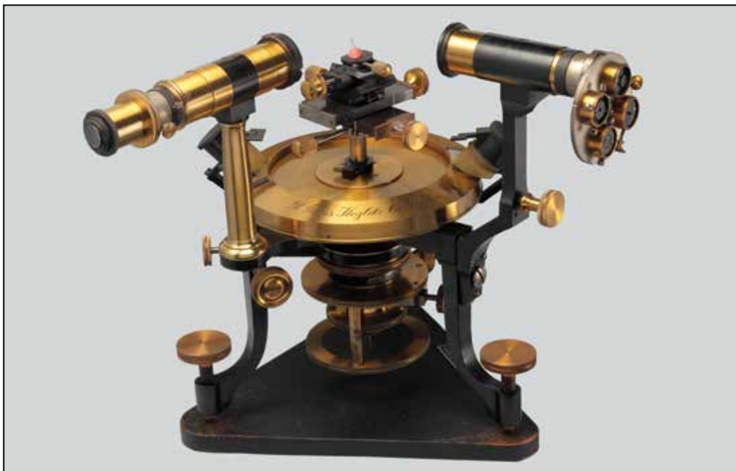
Goniometro a riflessione ad un cerchio, Modello IVa della ditta R. Fuess di Steiglitz, Berlino. Diametro del cerchio: 15 cm. Primi anni del Novecento. Foto R. Appiani.
