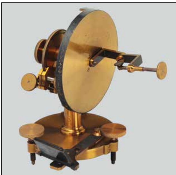
Goniometro a riflessione del tipo "di Wollaston". Diametro del cerchio: 11 cm. Costruttore "J. Duboscq, Paris, metà Ottocento. Foto R. Appiani.
