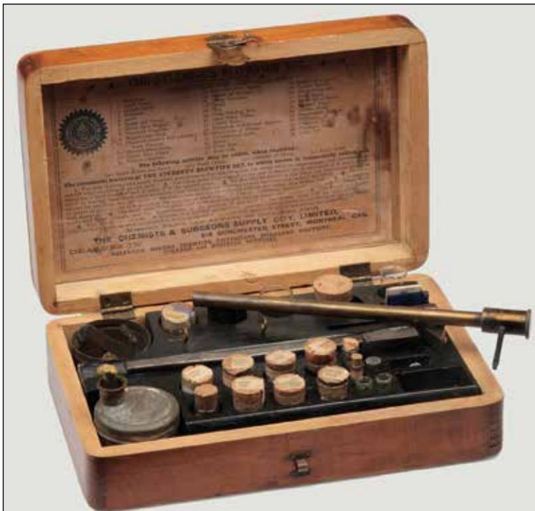
Cannello, lampada a grasso, reagenti ecc. sono contenuti in una cassetta di legno da 23×15 cm, definita nell'etichetta come The Students Blowpipe Set. Un raro esempio di laboratorio portatile canadese. Costruttore: The Chemist's & Surgeons Supply Co, Montreal. 1910 ca. N° inv. 095.
