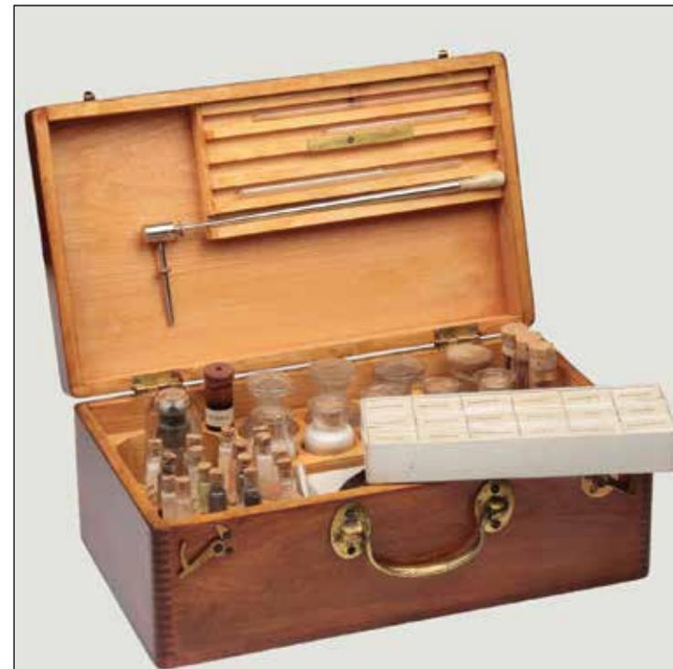
Una robusta cassetta di legno di 37×23×13 cm con cannello, lampada ad alcol, reagenti e pochi semplici accessori. Un esemplare molto usato, certamente in Colorado, probabilmente ai tempi della corsa all'oro in quello stato. Ex Colorado School of Mines, Boulder. Costruttore ignoto, 1860 ca. N° inv. 097.
